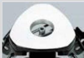
Un support parfaitement adapté, pour une grande qualité de mesure. La surface est polie afin d'être parfaitement plane.
