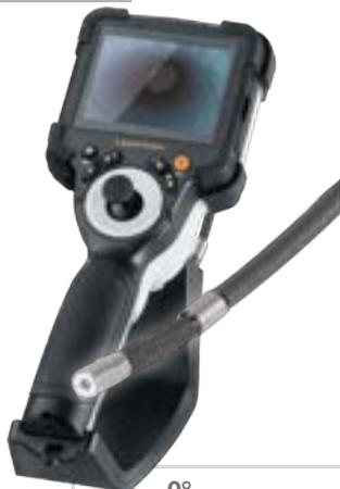
**Système professionnel de vidéo inspection avec une caméra flexible Inspector 3DX et un contrôle 3D de la tête de caméra**
