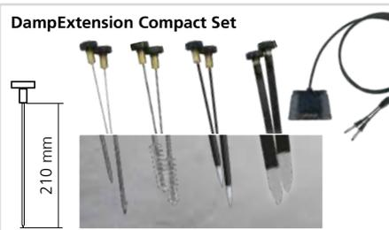
Inclus : DampMaster Compact Plus, capuchon de protection à fonction d'autotest, DampExtension Compact Set : DeepElectrodes Compact avec ExtensionCable, piles, mallette de transport
