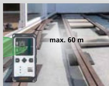
Les récepteurs laser reconnaissent les lignes lasers quelque soit la luminosité ambiante. En l'occurrence, les lignes laser pulsent à haute fréquence. Ce signal laser est reconnu par le récepteur jusqu'à une distance de 60 m.
